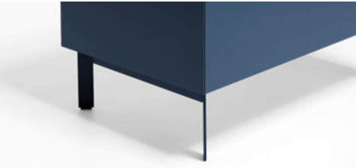
Untergestell mit Diagonal-Füßen - 17 und 27 cm hoch Diagonal-Füße führen die seitliche Gehrung fort. Farben: Mattlacke, edelstahlfarbig, brüniert Oben verstellbar um -0,3/+1,3 cm. Bis Breite 240 cm mit 2 Außenfüßen. Ab 160 cm Breite und 3 Raster Höhe mit zusätzlichem Mittelfuß. Breite > 240 cm grundsätzlich mit Mittelfuß.
